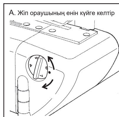
А. Жіп ораушының енін күйге келтіру Бұрылып реттеуші, ұлғайтыңыз немесе орама енін азайтыңыз, есу бойынша - кеңейту, азайту
