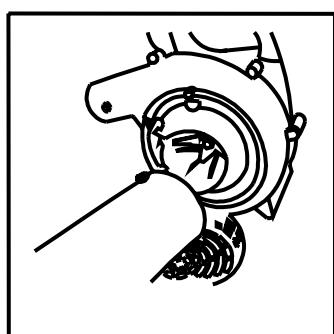
СОЕДИНИТЕ ВПУСКНЫЕ ТРУБЫ № 1 И № 2, ОТ-КРОЙТЕ КРЫШКУ ВЕНТИЛЯТОРА, ВСТАВТЕ ТРУБУ В ПАЗ.
