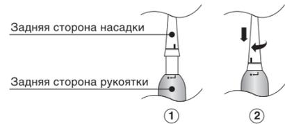
Фиксация насадки происходит в момент совмещения отметок «тире» на задней стороне насадки и «точка» на задней стороне рукоятки.
