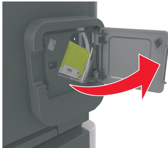
**3** Нажмите на фиксатор держателя кассеты со скобами и выньте держатель из принтера.
