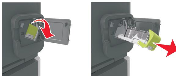
**4** С помощью металлической скрепки поднимите ограничитель прошивочных скоб и удалите все выпавшие скрепки.
